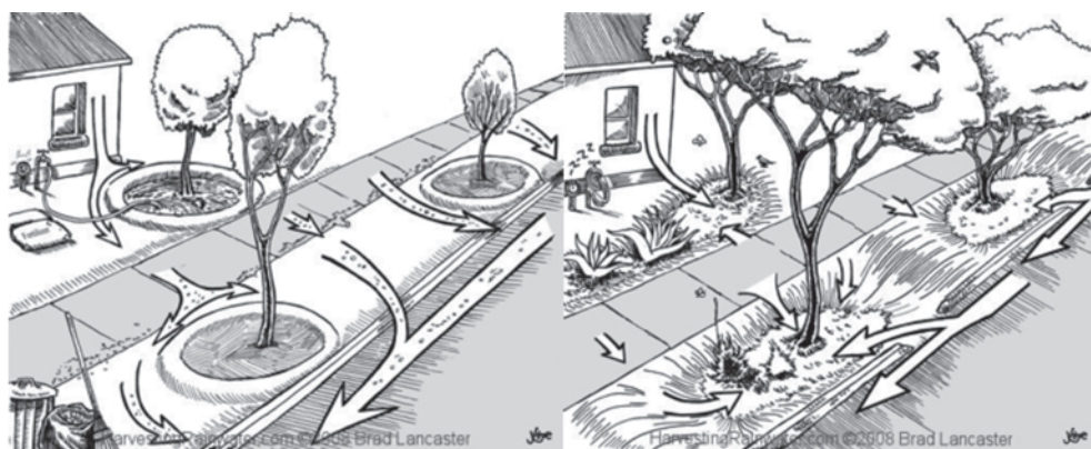
Figura 53. Principios básicos para el diseño de un sistema de captación de aguas lluvias en jardines y calles. Imágenes cortesía de Brad Lancaster, www.HarvestingRainwater.com .
